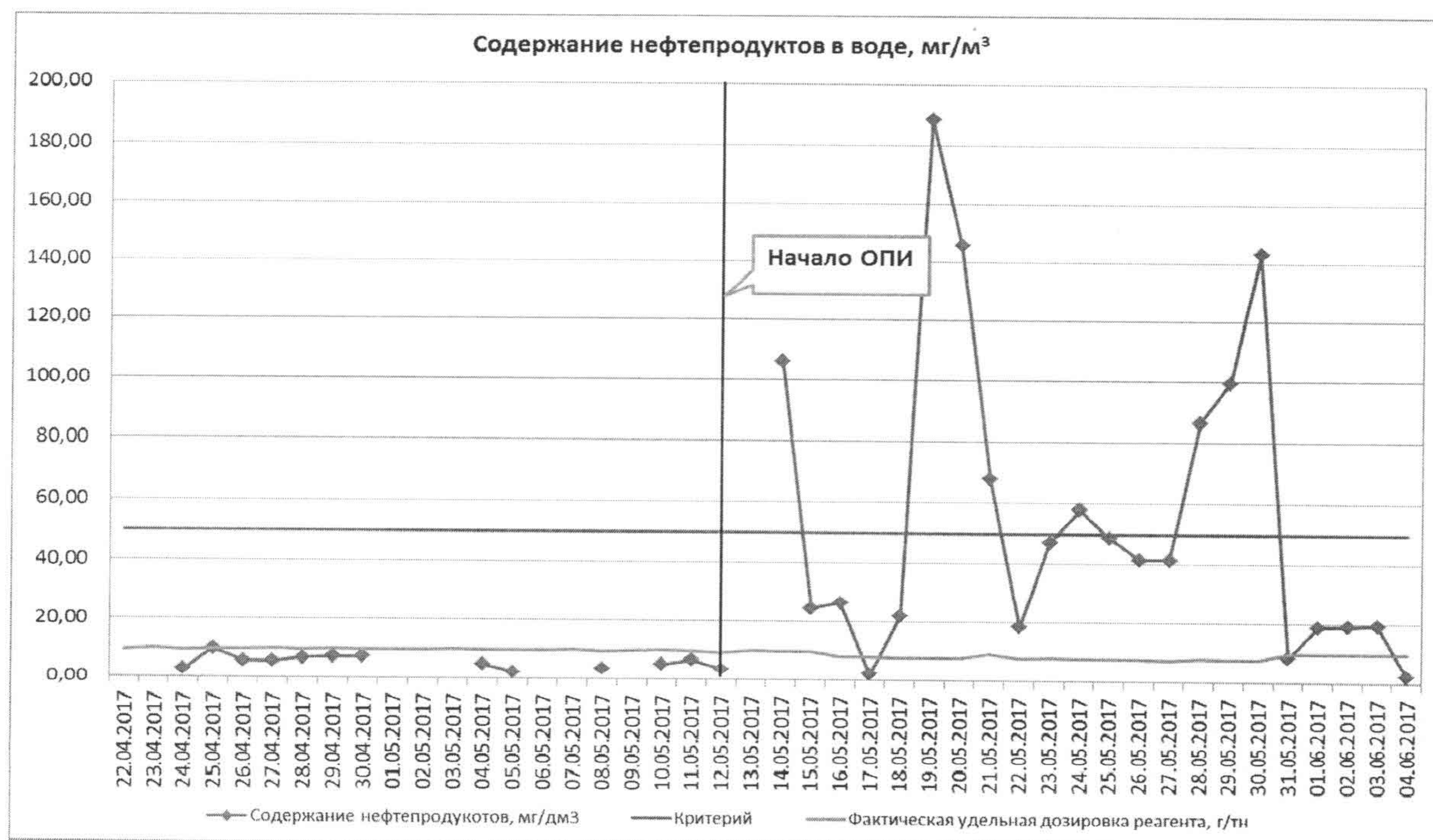
График 17. Сравнение действия базового и испытуемого реагента на УПСВ-11
