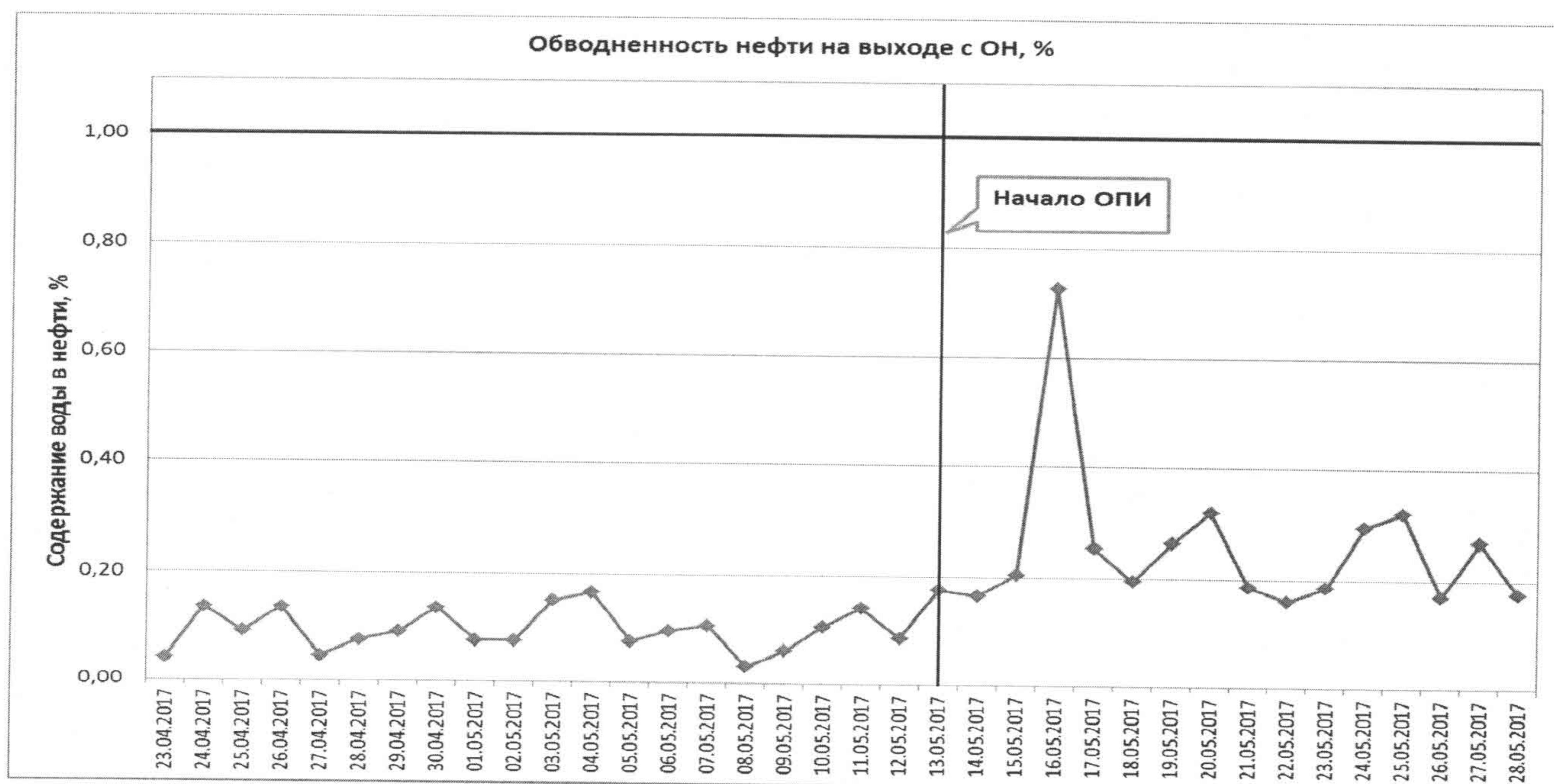
График 8. Среднесуточные показатели содержания воды в нефти на выходе с УПСВ-2.
