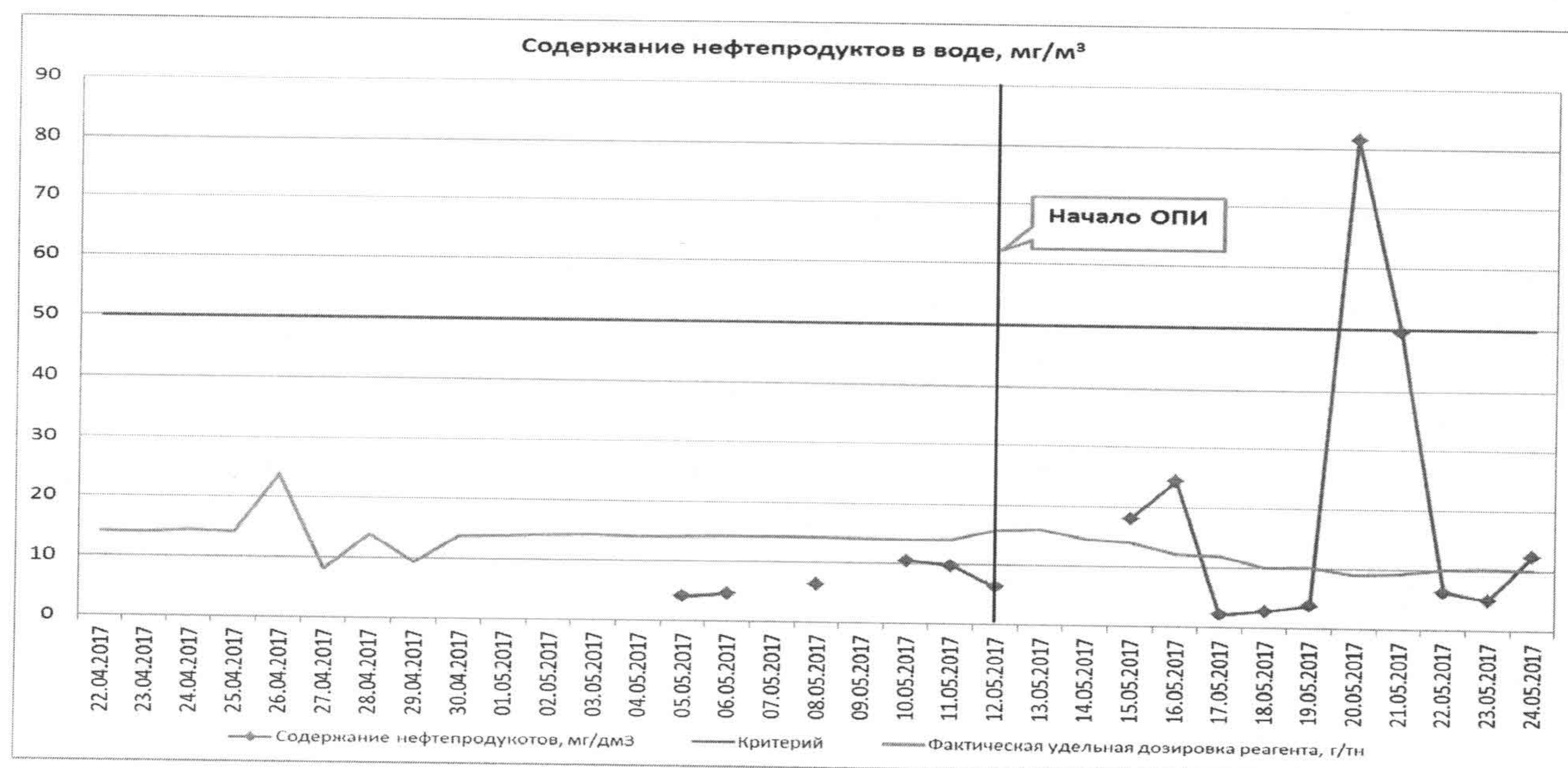
График 13. Сравнение действия базового и испытуемого реагента на УПСВ-4
