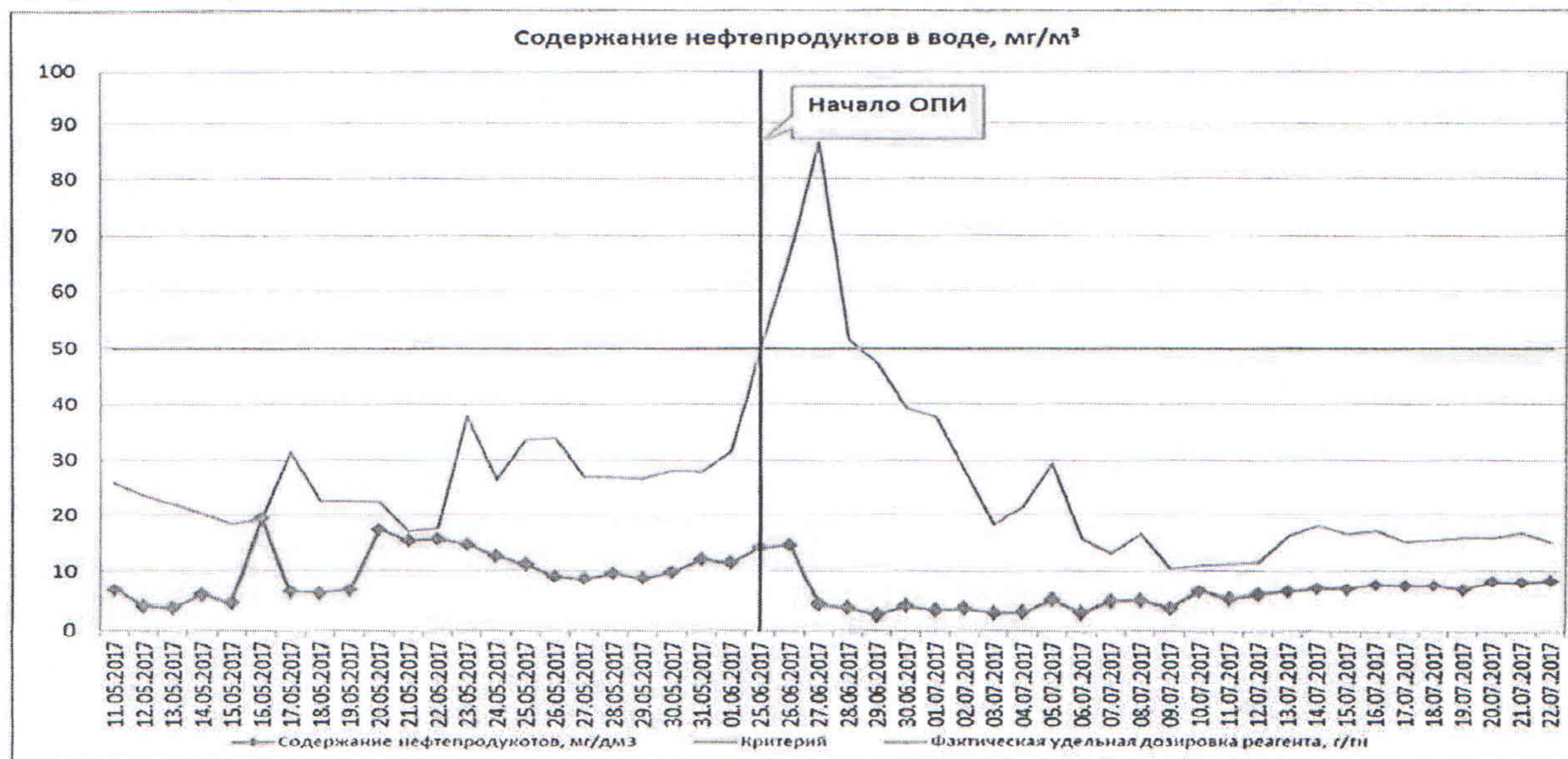
График 12. Сравнение действия базового и испытываемого реагента на УПН «Малореченское»
