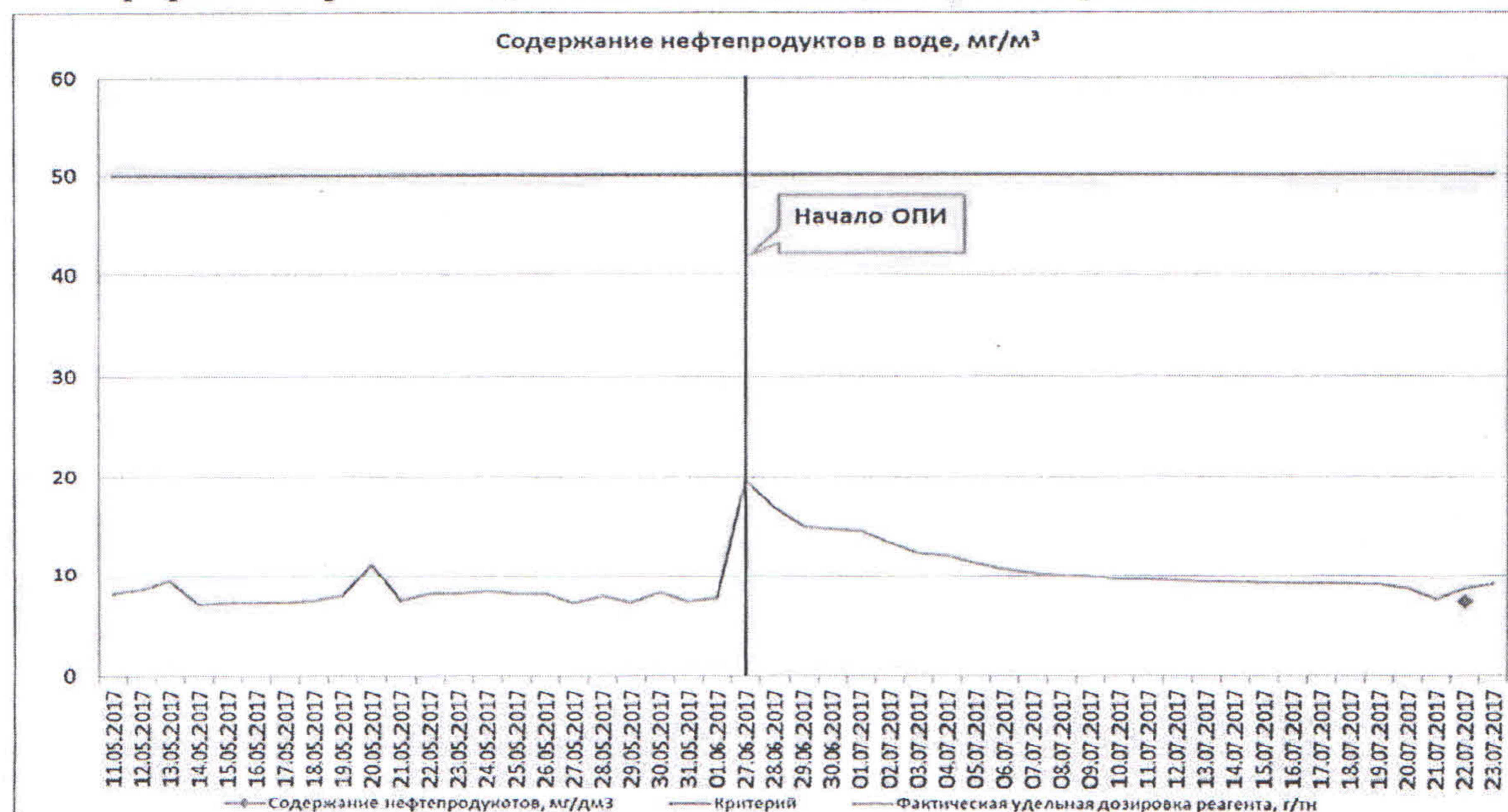
График 14. Сравнение действия базового и испытуемого реагента на УПН «Чкаловская»
