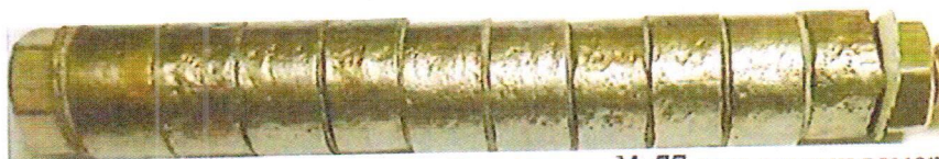
Рисунок 2 – Фото образцов свидетелей коррозии № 77 при снятии замера фона.
